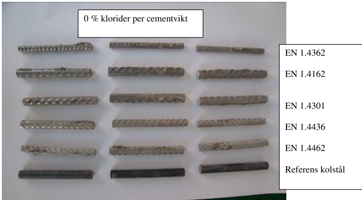
Figur 23 Utseendet hos provstänger av rostfritt stål och kolstål efter två års exponering utomhus ingjutna i betong (OPC C45/55, vbt 0,45) utan klorider.
