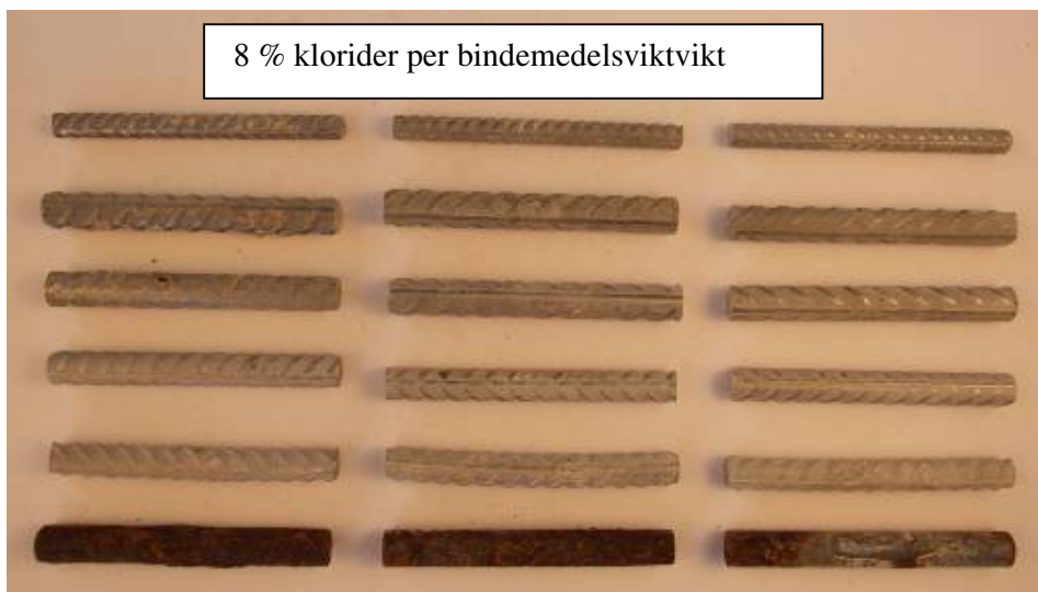
Figur 39 Utseendet hos provstänger av rostfritt stål och kolstål efter två års exponering utomhus ingjutna i betong (GGBFS C32/40, vbt 0,45) med 8 % klorider
