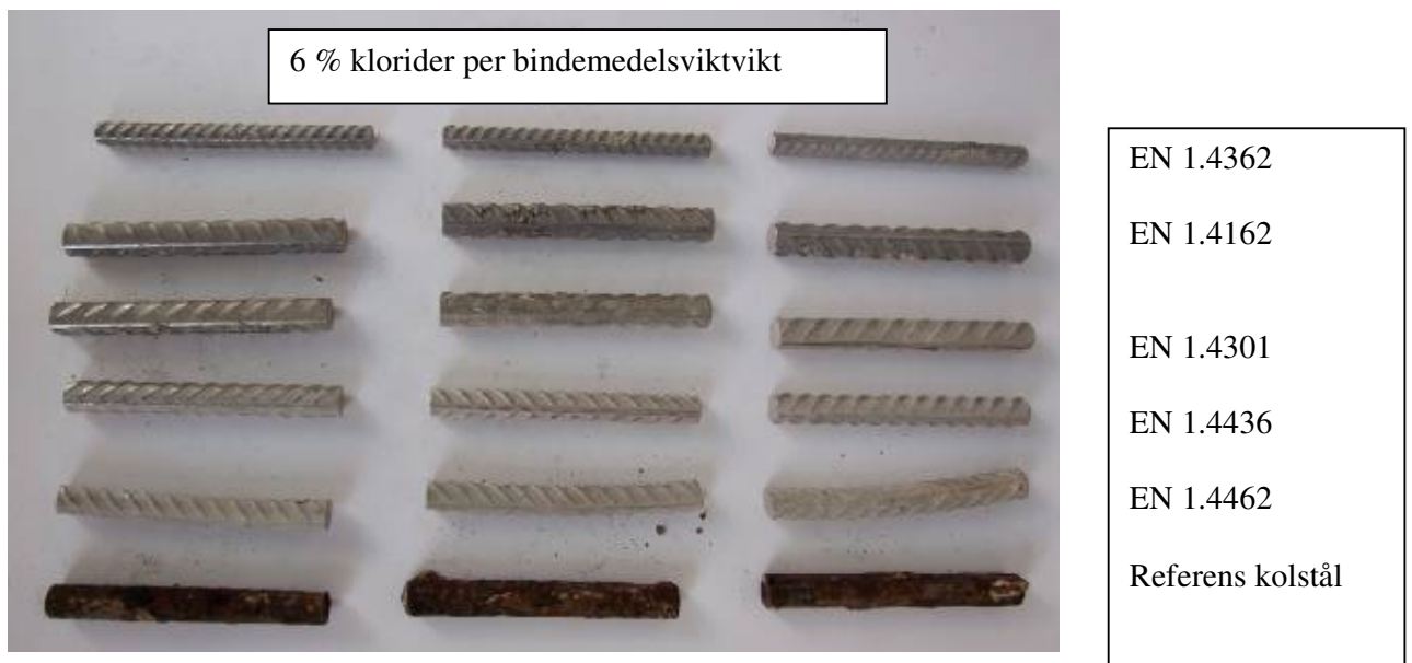
Figur 26 Utseendet hos provstänger av rostfritt stål och kolstål efter två års exponering utomhus ingjutna i betong (OPC C45/55, vbt 0,45) med 6 % klorider.
