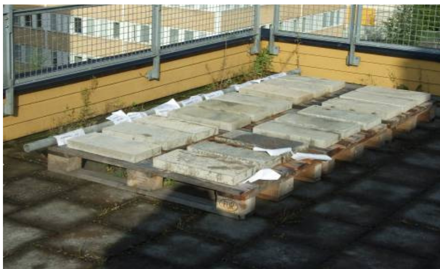
Figur 21 Betongblock med ingjutna provstänger av rostfritt stål och kolstål. Betongblocken har exponerats utomhus i två år i Stockholm
