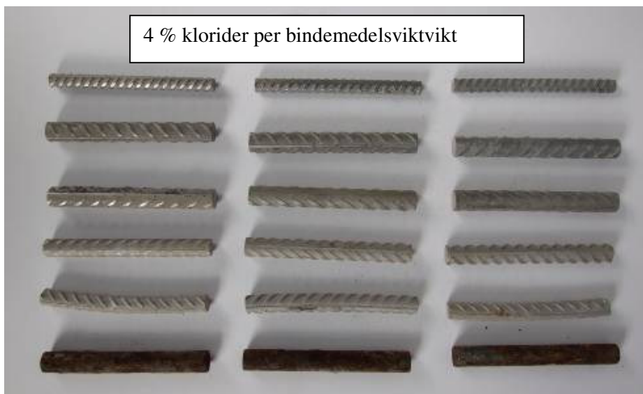
Figur 31 Utseendet hos provstänger av rostfritt stål och kolstål efter två års exponering utomhus ingjutna i betong (PFA C32/40, vbt 0,45) med 4 % klorider.
