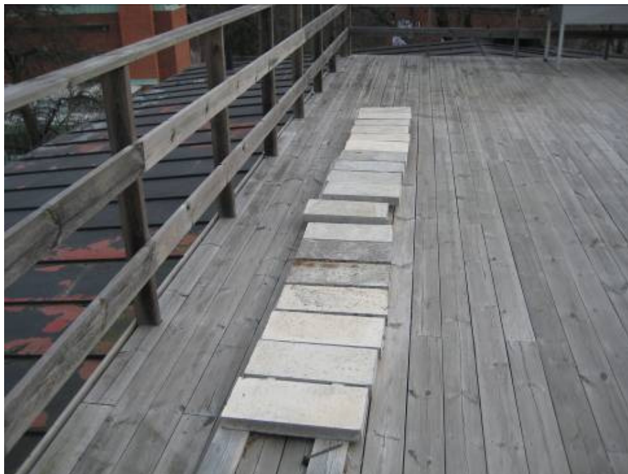
Figur 13 Utomhusexponering av provstänger av rostfri armering och kolstål ingjutna i betongblock med höga kloridhalter.
