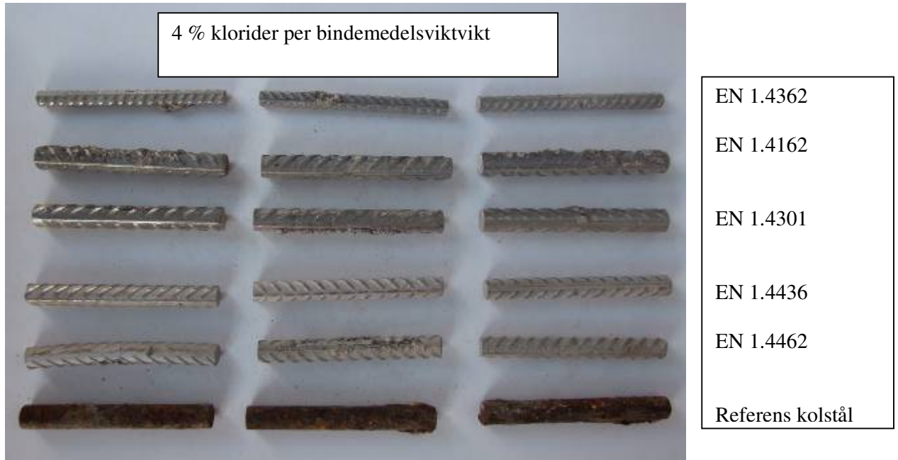
Figur 25 Utseendet hos provstänger av rostfritt stål och kolstål efter två års exponering utomhus ingjutna i betong (OPC C45/55, vbt 0,45) med 4 % klorider.
