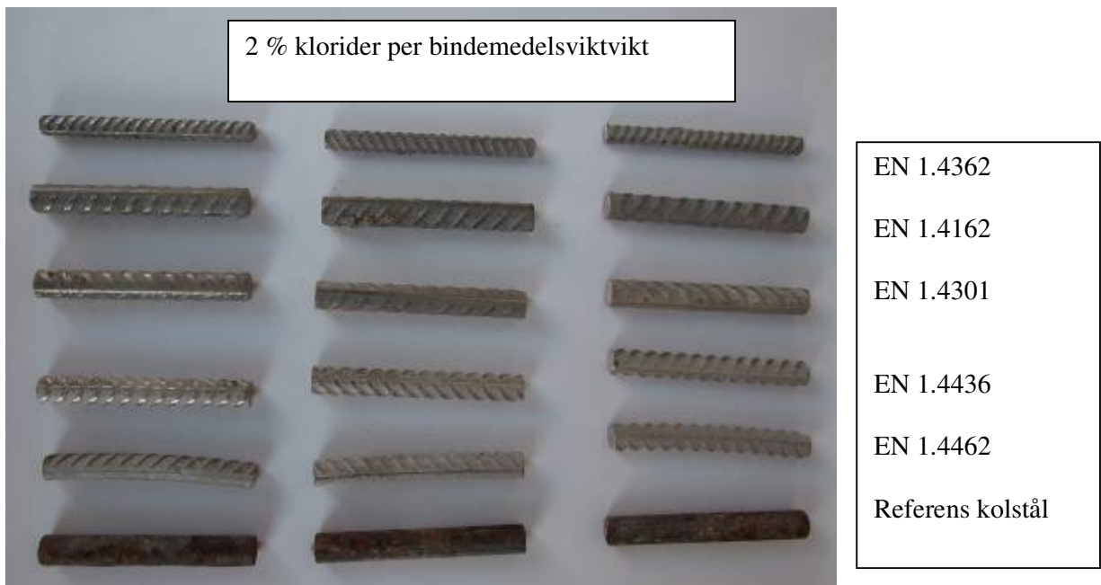
Figur 24 Utseendet hos provstänger av rostfritt stål och kolstål efter två års exponering utomhus ingjutna i betong (OPC C45/55, vbt 0,45) med 2 % klorider.
