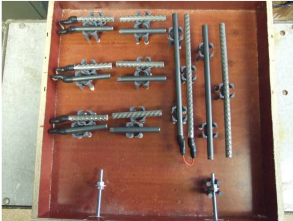
Figur 9 Betongform med provstänger i olika höjdnivåer färdiga för ingjutning. Kamstängerna är av rostfritt stål och de släta stängerna är av låglegerat kolstål
