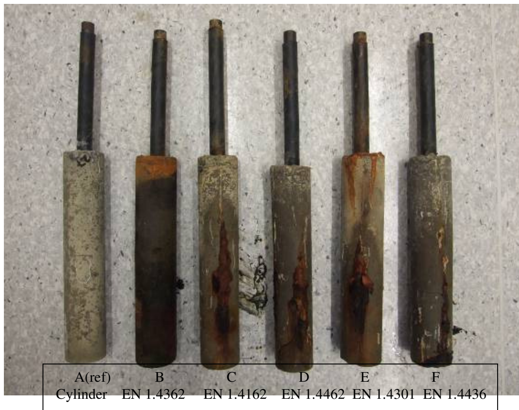
Figur 41 Provstänger av kolstål ingjutna i betong har exponerats 8 månader ihopkopplade med olika rostfria stålrör nedsänkta i ett vattenbad med 3 % NaCl. Prov A ingen ihopkoppling, För prov B-F har provstängerna av kolstål varit ihopkopplade med olika rostfria stålrör.
