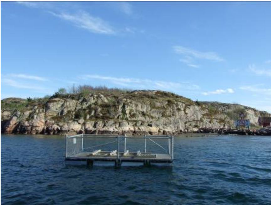
Figur 12 Bilden visar flotten vid Bohus Malmön där betongblocken exponerats.
