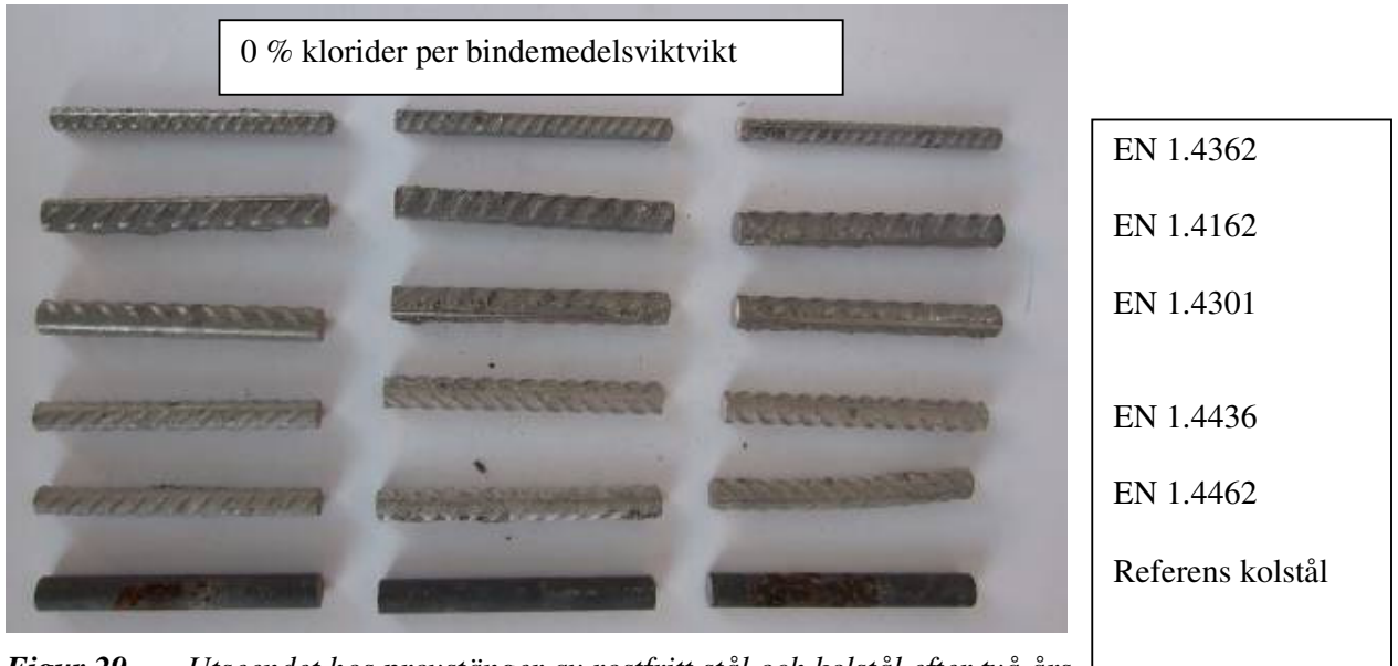
Figur 29 Utseendet hos provstänger av rostfritt stål och kolstål efter två års exponering utomhus ingjutna i betong (PFA C32/40, vbt 0,45) utan klorider.
