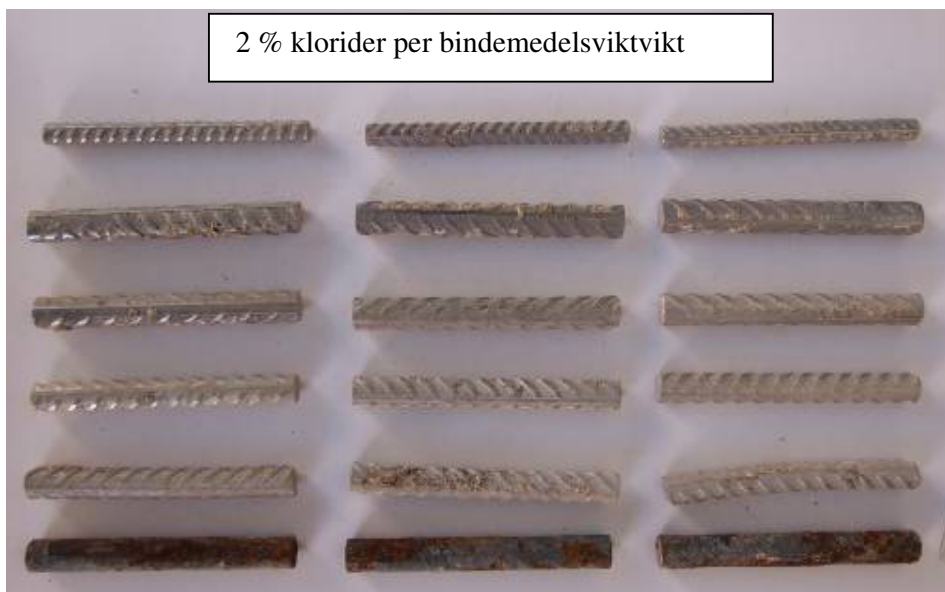
Figur 36 Utseendet hos provstänger av rostfritt stål och kolstål efter två års exponering utomhus ingjutna i betong (GGBFS C32/40, vbt 0,45) med 2 % klorider
