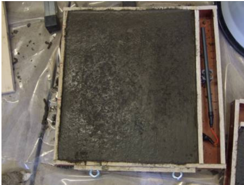
Figur 10 Provstång av kolstål som är ihopkopplad med en provstång ingjuten i kloridhaltig betong. Efter det att betongen härdat avlägsnas skiljeväggen och utrymmet till höger i formen fylls med betong utan tillsatta klorider.
