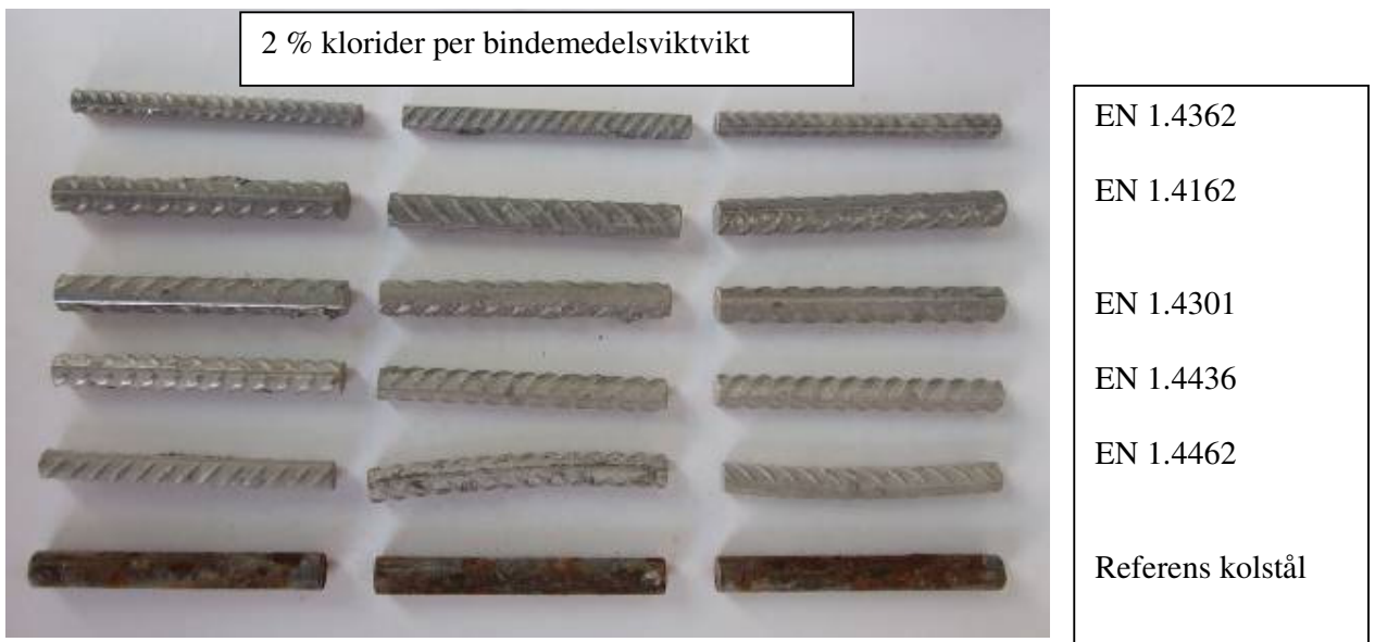
Figur 30 Utseendet hos provstänger av rostfritt stål och kolstål efter två års exponering utomhus ingjutna i betong (PFA C32/40, vbt 0,45) med 2 % klorider.
