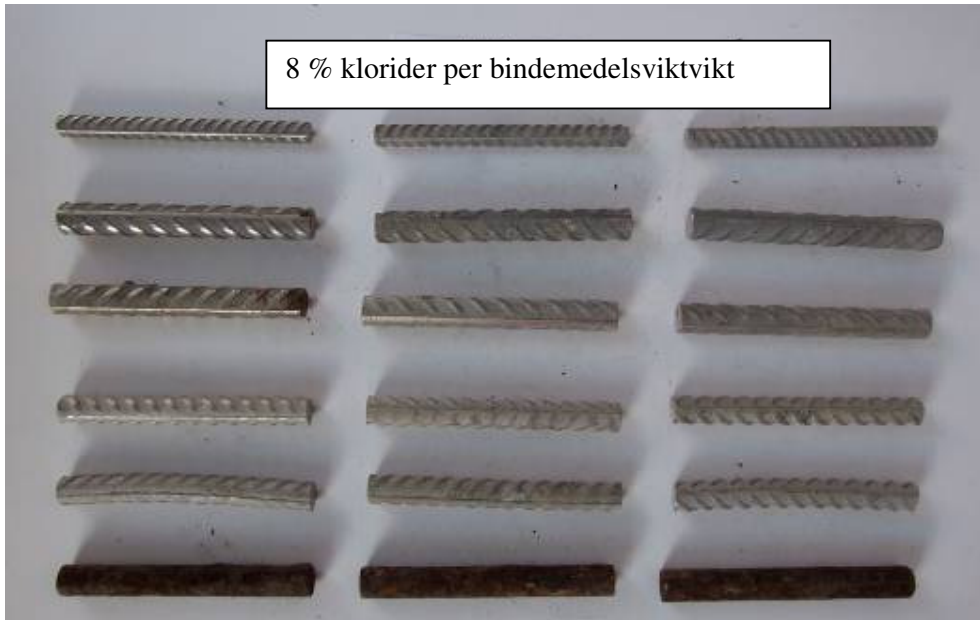
Figur 33 Utseendet hos provstänger av rostfritt stål och kolstål efter två års exponering utomhus ingjutna i betong (PFA C32/40, vbt 0,45) med 8 % klorider
