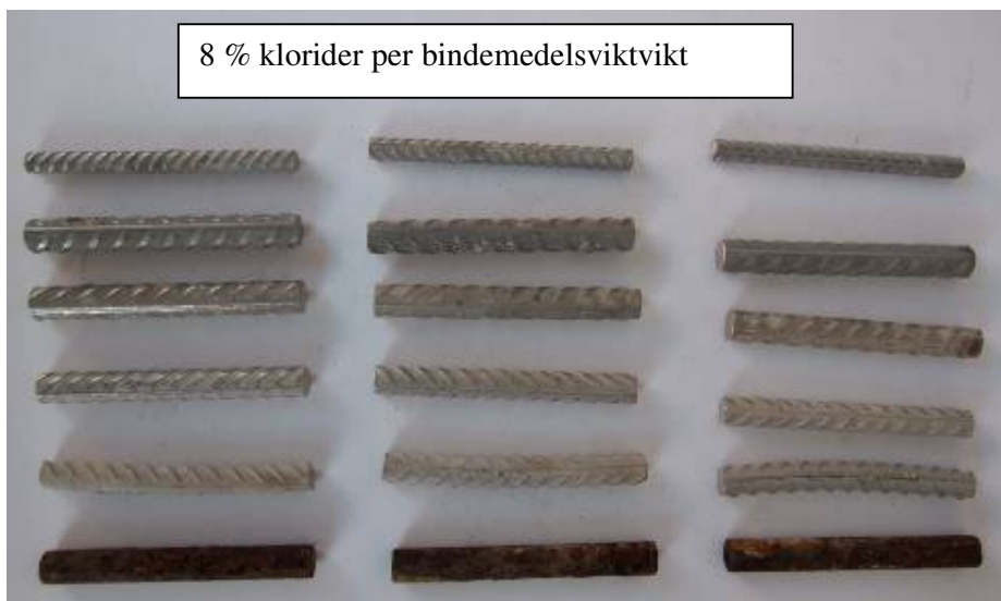
Figur 27 Utseendet hos provstänger av rostfritt stål och kolstål efter två års exponering utomhus ingjutna i betong (OPC C45/55, vbt 0,45) med 8 % klorider.
