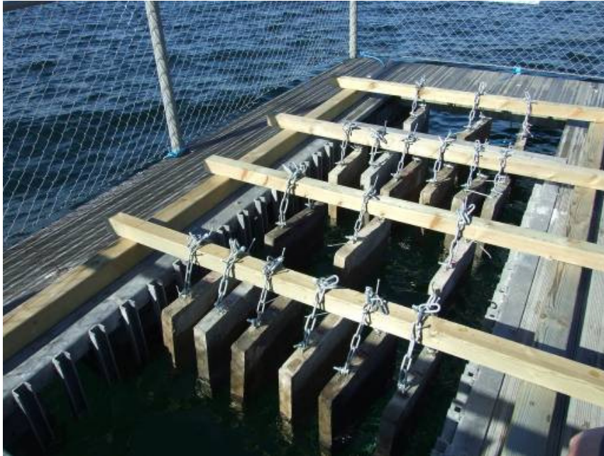
Figur 8 Bilden visar hur betongblocken exponeras delvis nedsänkta i havsvatten från flotten vid Bohus Malmö.
